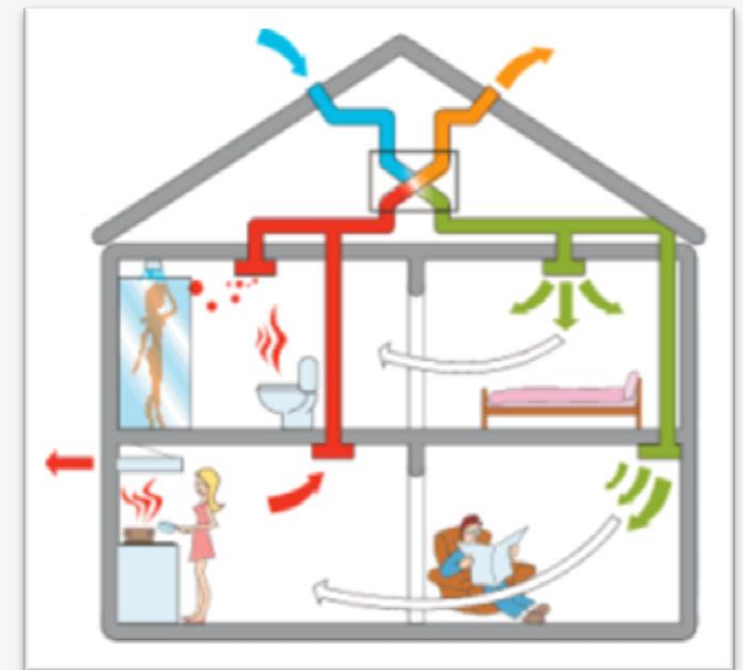
Principe d'une VMC Double flux, Source Infoenergie69
