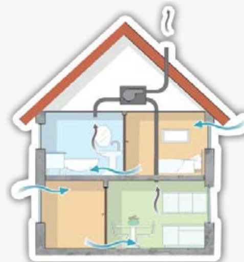
Ventilation mécanique Principe VMC simple flux - Source ADEME FC/CD39
