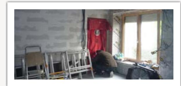
Test d'infiltrométrie - Source Ajena
